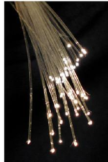
Le **fibre ottiche** sono filamenti di materiali vetrosi realizzati in modo da poter condurre la luce. Sono normalmente disponibili sotto forma di cavi.
